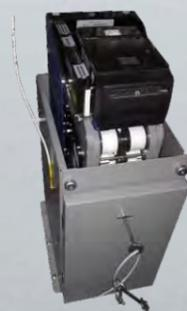
В Автоматической кассе устанавливается кожух с сейфовым замком для защиты от доступа технического обслуживающего персонала к устройствам приема и выдачи денежных купюр.
